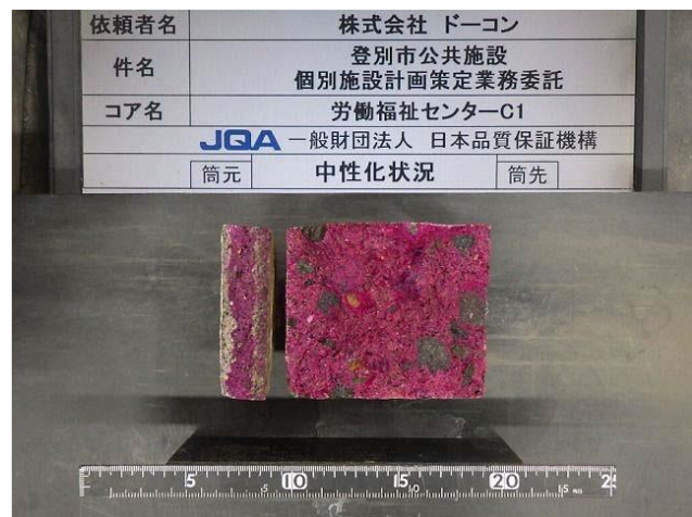
中性化試験の状況
