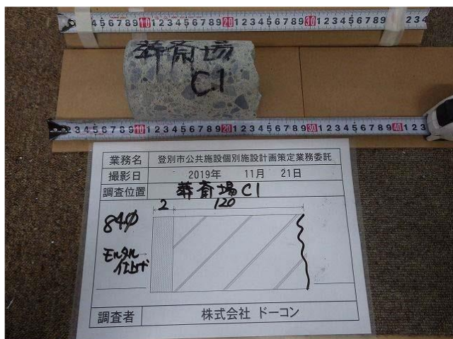
コンクリートコア採取の状況
