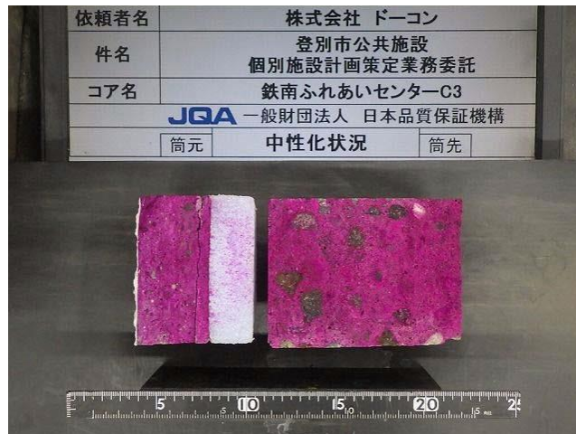
中性化試験の状況
