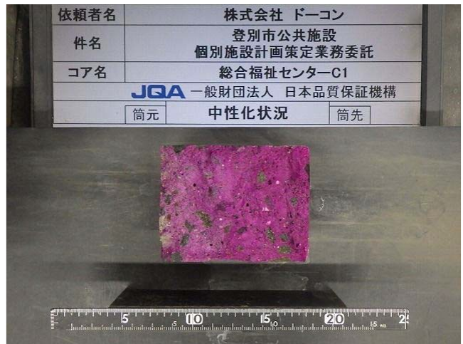
中性化試験の状況
