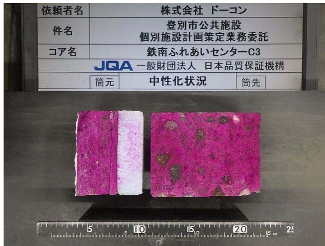
中性化試験の状況
