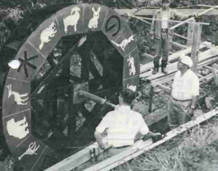
森の水車＝回転でオルゴール装置が動きメロディーが流れます
