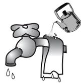
水道が凍結したときは、蛇口から床板までの給水管にタオルを巻き付け、全体が温まるようにお湯を少しずつかけると、軽い凍結であれば水が出ます(破裂する恐れがあるので、直接、熱湯はかけないでください)。
