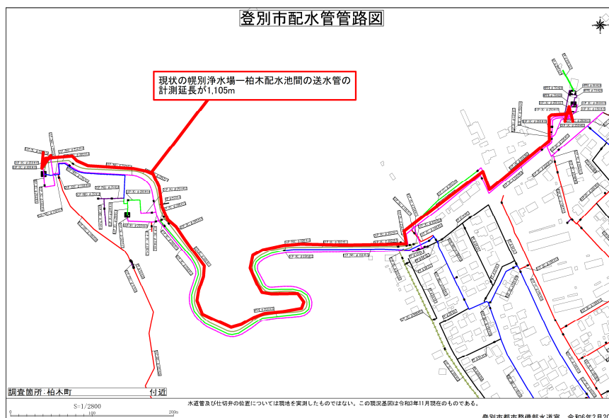
図 6.3 送水管布設位置
