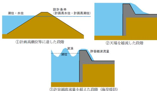
図-6 護岸・堤防の決壊条件イメージ
