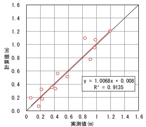
図- 13 2014年12月高潮の実際の浸水状況と計算結果の比較
