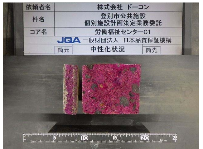
中性化試験の状況
