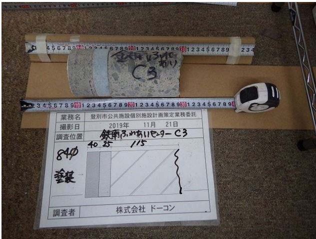
コンクリートコア採取の状況
