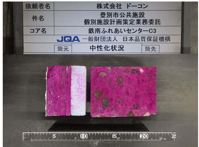
中性化試験の状況
