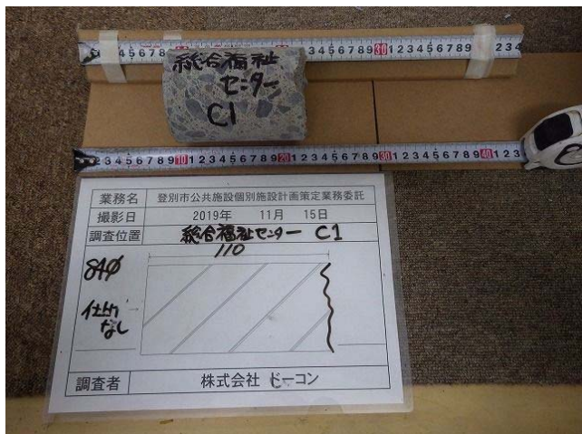
コンクリートコア採取の状況
