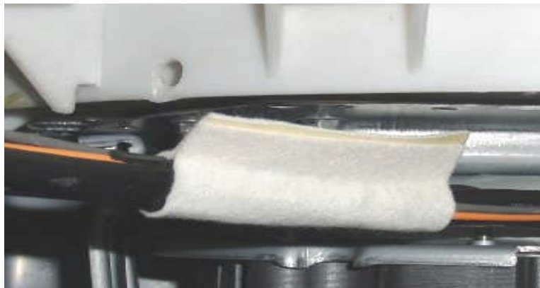
【②更に難燃フェルトで補強】
