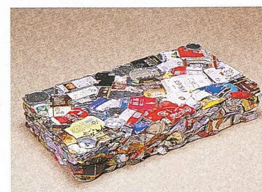
スチール缶 磁選機で選別したスチール缶を圧縮機で圧縮成形します。
