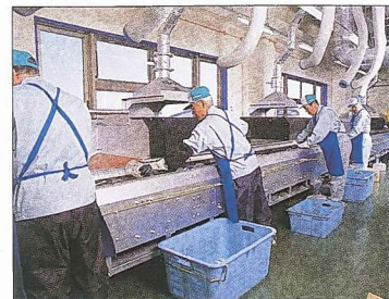
手選別コンベヤ 缶類は磁選機でスチール缶、手選別でアルミ缶を選別し、ビンは手選別で色選別します。
