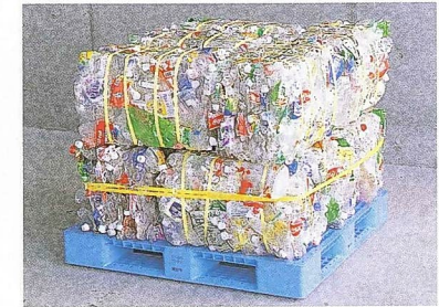
ペットボトル ペットボトルは圧縮機で圧縮梱包します。
