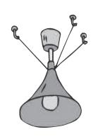
▼照明器具を補強しましょう 天井に直接取り付けられる 照明を使用する。
