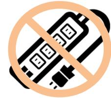
「たこ足配線」とは、テーブルタップのようなたくさんの挿し込み口があるコンセントに、複数の電気機器が接続されている状態のことをいいます。多くのコンセントでは定格電流が15アンペアとなっていますが、たこ足配線によって定格電流を上回る量の電力を使用すると熱を発生するようになり、最悪の場合は発火して火事に繋がってしまうおそれがあります。たこ足配線を行わないようにし、テーブルタップはこまめに掃除をしましょう。
