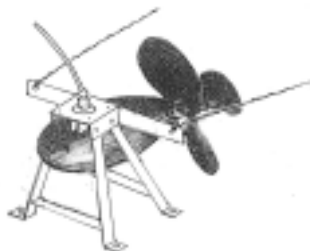
図 3-9-3 渓流発電機(最大出力100W、全長36.7cm、直径21.3cm、10kg)
